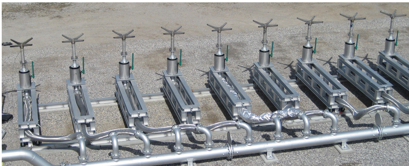
我们独特的多燃烧器测试设施可以通过轨道系统实现多燃烧器配置,从而实现满负荷燃烧器的多维测试
